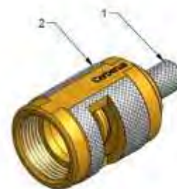
Рис. 7.2 Экстрактор OUTEX 100 1-Винт; 2-Корпус
