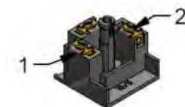
Рис. 7.3 Подключение пусковой цепи электромагнитного привода POUSSAX24 1(+) 2(-)
